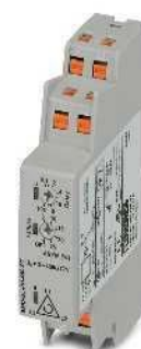
Реле контроля фаз Контроль последовательности чередования, обрыва и асимметрии фаз
