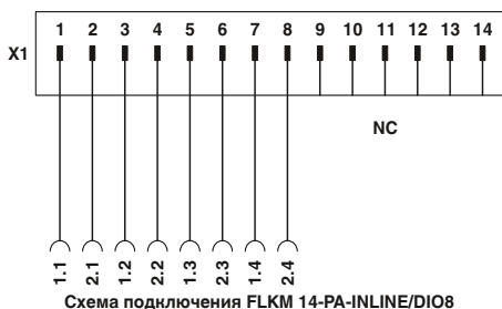
Схема подключения FLKM 14-PA-INLINE/DIO8
