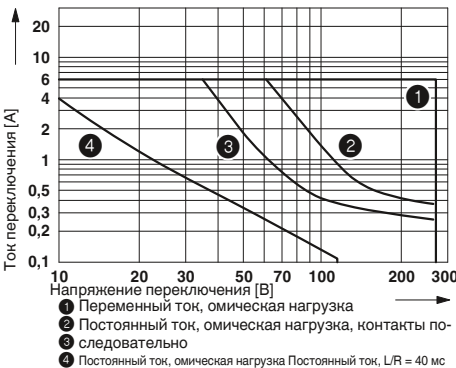
Электрическая мощность отключения для PLC...21HC/MS на базе реле с 1 перекл. контактом
