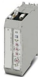
Мультиплексор HART, 32-канальный
